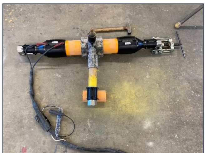
Abbildung 6: Vorbereitung der Prüflinge für H2 Prüfungen
