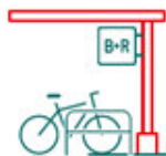
Standardüberdachungen – unkompliziert und wettergeschützt. Die lichte Höhe der Fahrradüberdachung ist so konzipiert, dass auch Doppelstockparker problemlos Platz finden.
