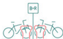
Reihenbügelanlagen – einfach und schnell. Die preiswerte Bügelanlage wird montagefestig angeliefert und lediglich im Boden verschraubt.
